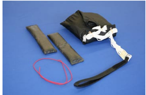
3.6. Kontrolle ob alles Packwerkzeug das verwendet wurde auch wirklich entfernt wurde.
