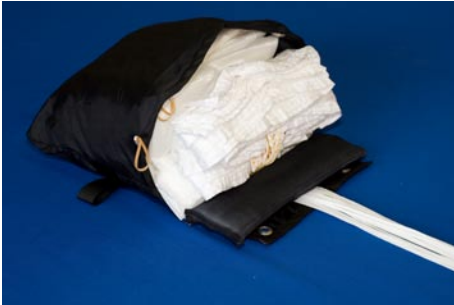
3.3. S-Schläge in den Innencontainer einlegen und gegen Herausrutschen mit Packgewicht beschweren.
