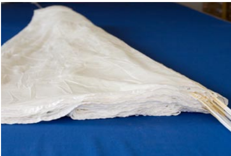
2.5. Zum Legen des S-Schlages wird das komplette Fangleinenbündel incl. der linken Bahnen leicht angehoben und komplett zu 2/3 über die rechten Bahnen gelegt.
