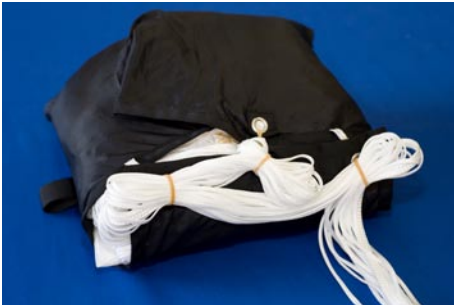
3.5. Die 3 x 8er Fangleinenbündel in den Innencontainer auf die Kappe legen und mit den verbleibenden Fangleinen den Containerdeckel von der mitte nach außen verschließen.
