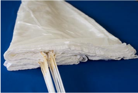
2.7. Anschließend die kompletten linken Bahnen zurück über die Mitte (Fangleinen) legen.
