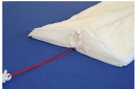
1.2. Hilfschnur durch die Packschlaufen ziehen und am oberen Ende des Packtisches befestigen:
