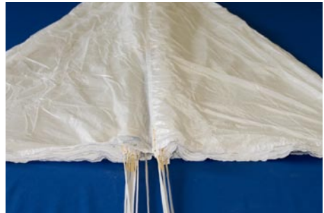
2.4. Vor dem Legen des S-Schlages die Fangleinen nochmal auf kreuzungsfreien Verlauf kontrollieren.
