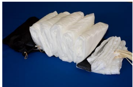
3.2. Restliche Kappe in kleinen S-Schlägen vor den Innencontainer sortieren.
